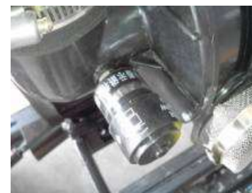
Сигнал блокировки воздушного фильтра сухого типа
