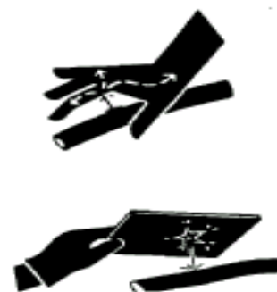
Рис. 1-9 Утечка в гидравлическом трубопроводе
