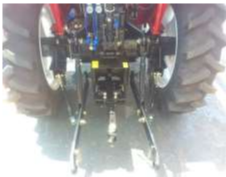
Рис. 3-59 Заводское состояние техники с тяговой штангой в середине
