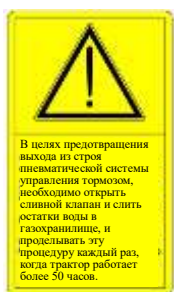
Рис. 1-31 Предупредительные идентификаторы пневматического тормоза
