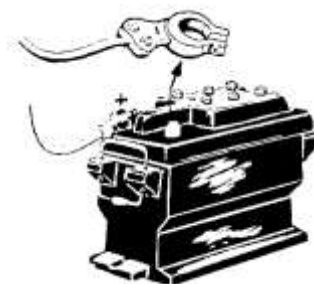
Рис. 1-15 Техническое обслуживание электрических частей
